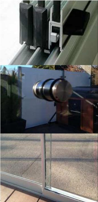
Die einzelnen Elemente laufen auf kugelgelagerten Laufrollen und sind mit Mitnehmern ausgerüstet, die das nächste Element beim Schliessvorgang automatisch mitziehen. Die Verriegelung erfolgt in der Regel mit einem Schnappverschluss.
